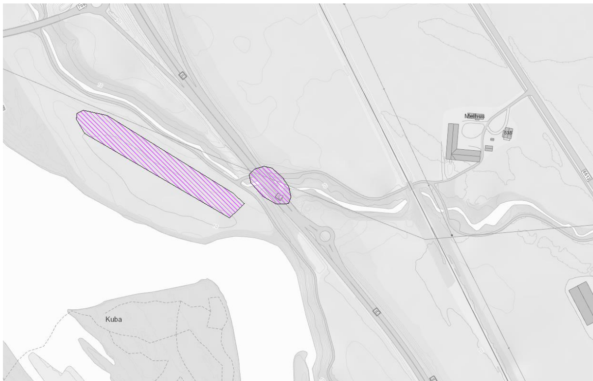
Figur 3: Utsnitt av kart for aktsomhetsområder for kvikkleire. Lilla skravur er registrerte områder med kvikklere av Statens vegvesen. Kilde: atlas.nve.no.
